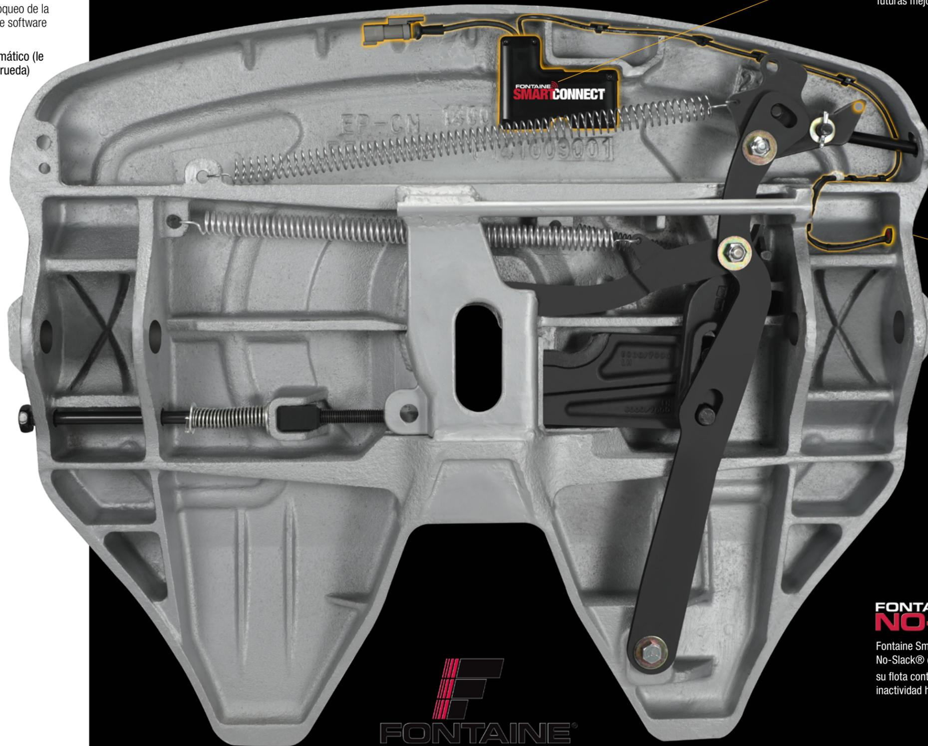
El módulo de control Fontaine SmartConnect™ cuenta con capacidad de conexión por cable para la comunicación de gestión de flotas y futuras mejoras de software.
